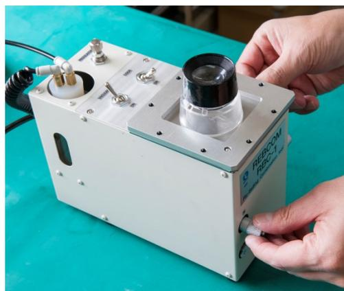
リボウリング用マスクも同様に、位置決めを行い、必要に応じて微調整して位置合わせします、位置の確認後、パッケージ抑えツールを乗せ、パッケージとメタルマスクの位置が変わらないように固定させます。
