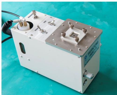
これ以後の作業は加熱を含めて、パッケージ保持台とメタルマスクおよびパッケージ抑え部が一体で行なわれます。ハンダボールの供給とセットには拡大鏡を使用します。
